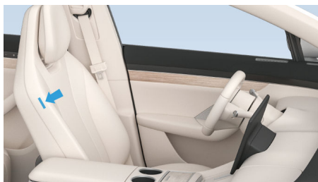
远端侧气囊（驾驶员侧）展开
