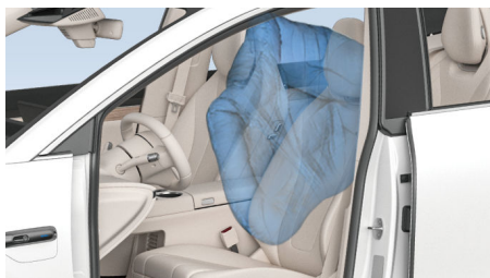
远端侧气囊（驾驶员侧）展开
