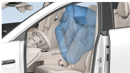
远端侧气囊（驾驶员侧）展开
