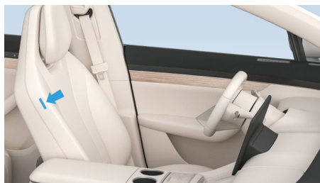
远端侧气囊（驾驶员侧）展开
