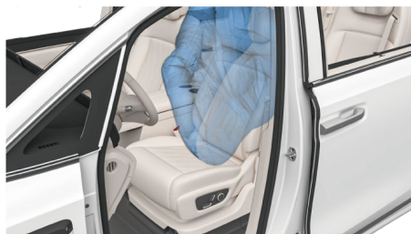
远端侧气囊（驾驶员侧）展开
