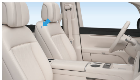
远端侧气囊（驾驶员侧）展开
